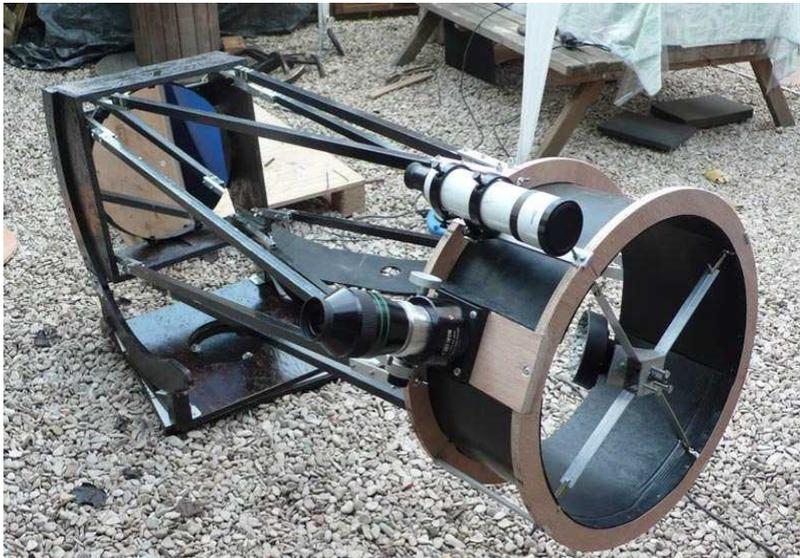
Voici l'image du dobson achevé. Equipé d'un oculaire d'un kilogramme et d'un viseur, le télescope reste bien équilibré.
