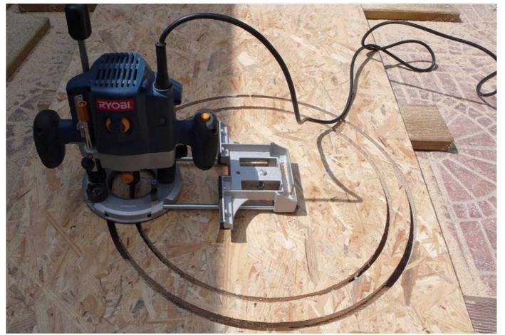
A l'aide d'une défonceuse avec plusieurs passes, découpez des cercles parfaits. Il est conseillé de commencer par l'extérieur pour finir par l'intérieur. C'est la partie la plus délicate à réaliser, soyez prudents et vigilants en utilisant ce genre de machine !
