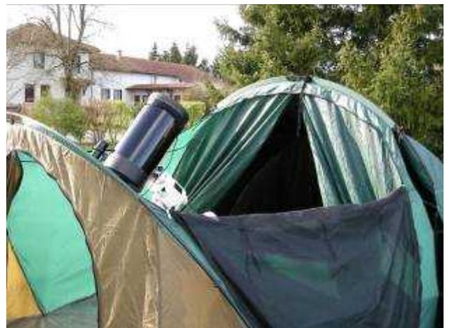
La particularité de cet observatoire mobile, c'est son ouverture dans le toit grâce à une fermeture éclair. En effet, il est nécessaire de débâcher la moitié de la toile du toit pour permettre l'observation. Cette opération peut paraître fastidieuse mais il n'en est rien. Elle se réalise en 5 minutes et surtout la présence du double toit vous prémunit des pluies les plus importantes. Durant notre séjour il a plu... beaucoup, beaucoup, beaucoup...
